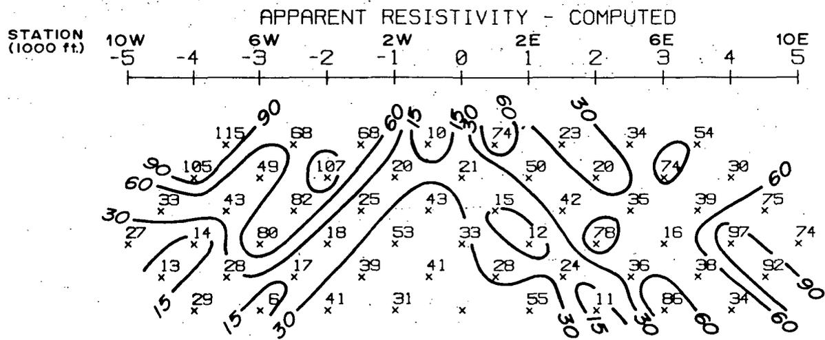
FIGURE A-1 COMPUTED MODEL, LINE MR1, MALPAIS AREA, ITERATION 8
